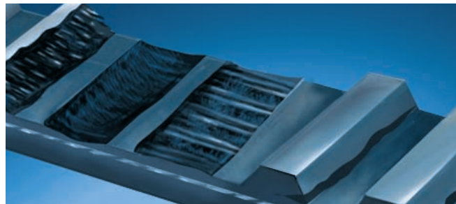
Износ боковых поверхностей зубьев Zużycie boków zębów Opotřebení boků zubů Uzura laterală a dinților
